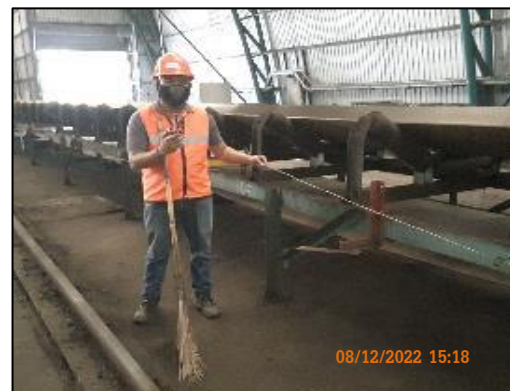
ภาพที่ 2.49 การทำความสะอาดสายพานลำเลียงถ่านหิน
