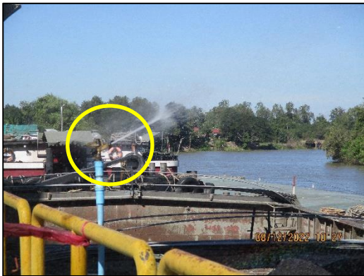
ภาพที่ 2.4 การติดตั้งสเปรย์น้ำบริเวณที่มีการลำเลียงถ่านหินขึ้นจากเรือ
